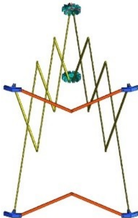
Рисунок Б.12 - Механізм ножиць нерівномірної довжини обручно-ребристої ферми [126].
